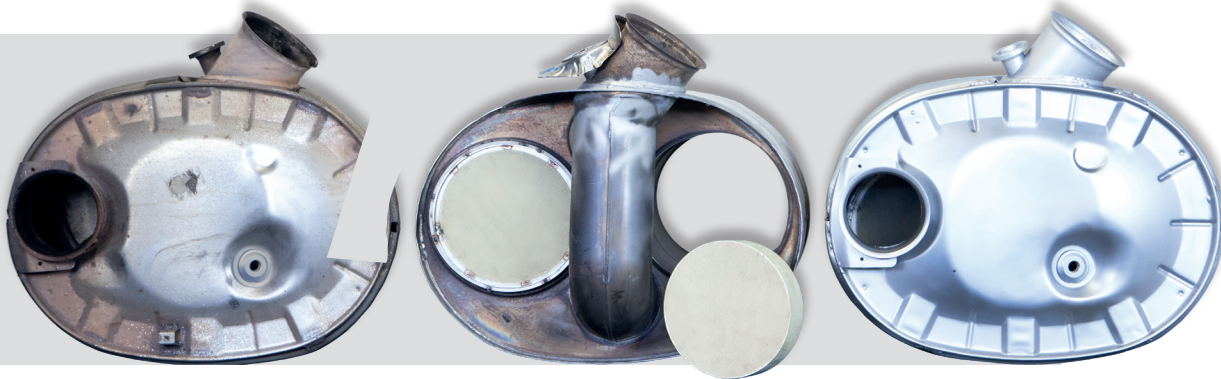
Reparaturbeispiel eines Katalysators für einen VOLVO FH/FM/Euro-5
